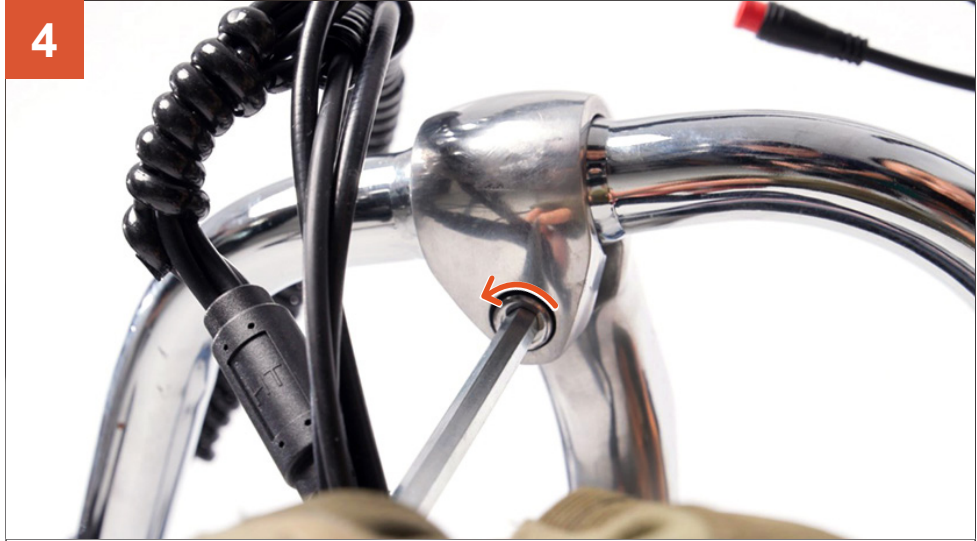
4 Loosen the handlebar binder bolt.
