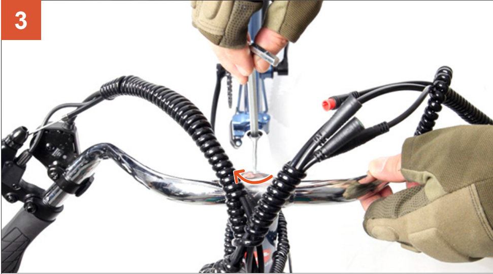
3 Tighten the top bolt.
